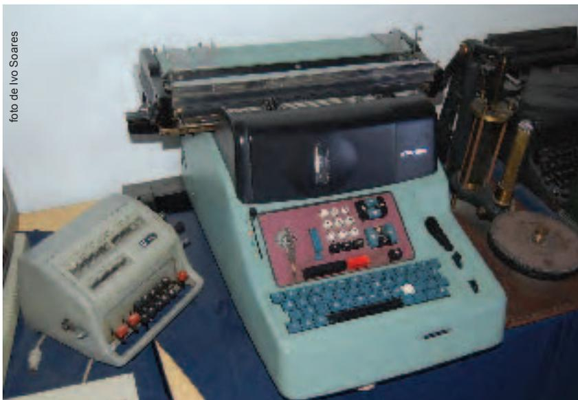
Máquinas de calcular mecânicas das marcas Odhner e Olivetti
